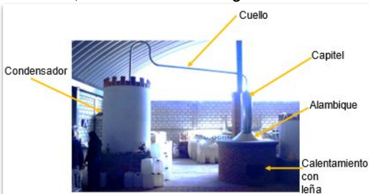
Figura 1. Componentes de la destilación solar de mezcal en la planta de mezcal Bravero, Miahuatlán de Porfirio Díaz, Oaxaca.
