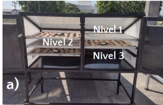
Figura 1. a) Secado solar con deshidratador solar mixto.
