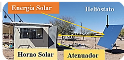
Figura 4. (a) Productos de la pirólisis solar (b) Horno solar para pirólisis de la Plataforma Solar de Hermosillo.
