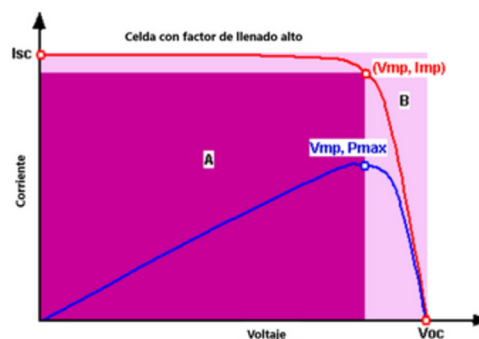
Figura 4. Curva típica de I vs. V de una celda solar.
