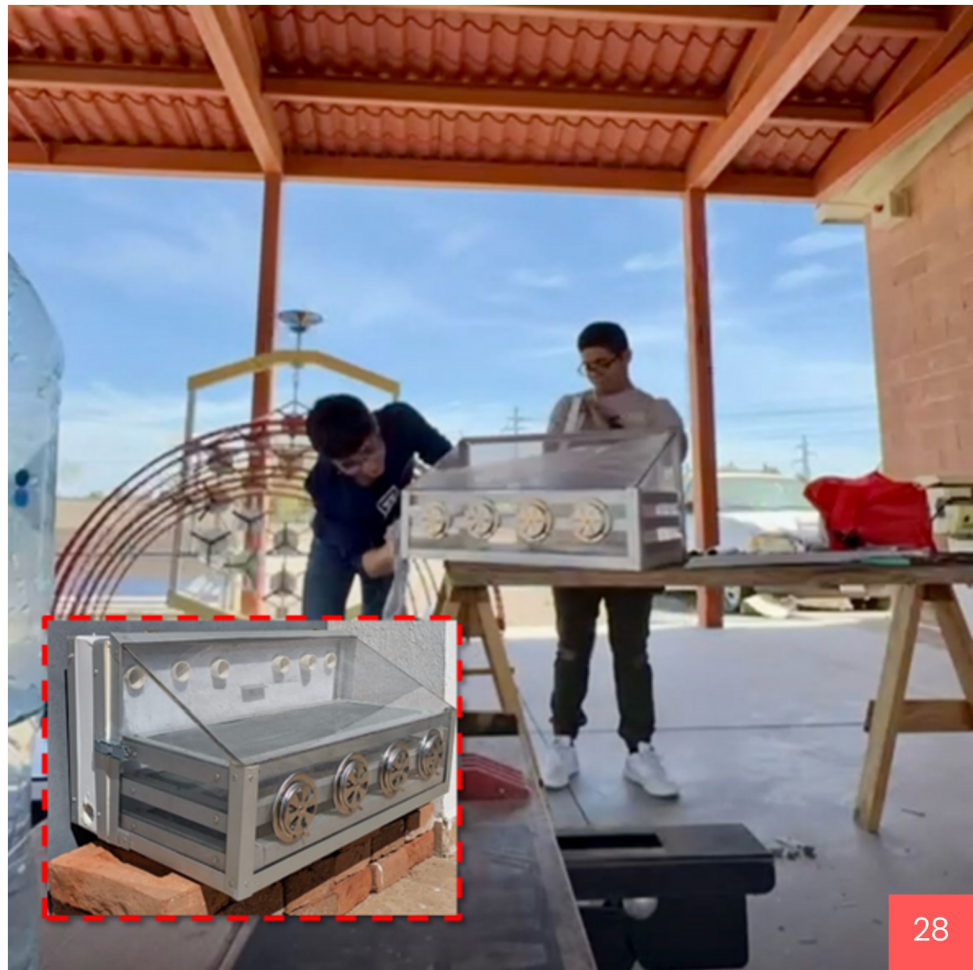
Figura 2. Prototipo físico del secador solar tipo invernadero. Los estudiantes Rubén A. Varela y José Mario Zamorano trabajando en la construcción del prototipo. (Fotografía propia)
